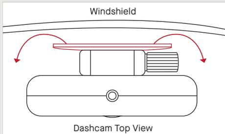
Orientez la caméra de tableau de bord de manière à ce que la caméra faisant face à la route se trouve en bas. Appuyez doucement jusqu'à ce que la caméra de tableau de bord soit fermement fixée au pare-brise.
