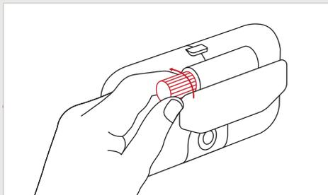
Ajustez la vis latérale avec votre doigt ou utilisez une clé mâle à six pans (non fournie) pour aligner l'angle de la caméra afin que la route et le conducteur restent bien visibles.
