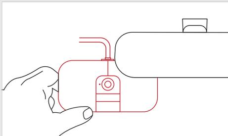
Maintenez la caméra de tableau de bord contre l'emplacement choisi avec le câble partant du haut. Ne retirez pas l'autocollant adhésif du support à ce stade.
